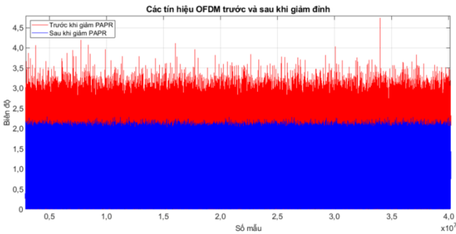
Hình 2.21. Tín hiệu OFDM trước và sau giảm PAPR bằng thuật toán lai ACE-CCNF
